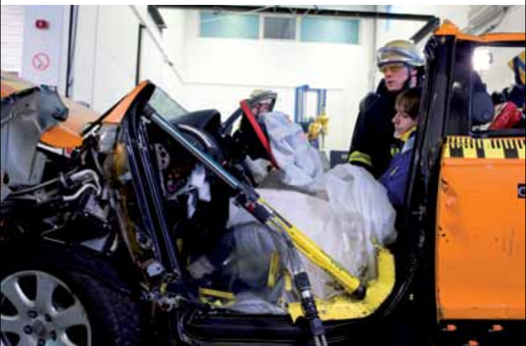
5. Agrandissement de l'espace-pieds dans l'habitacle à l'aide d'un vérin de sauvetage
